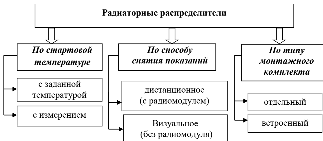
Рис. 3 – Разновидности радиаторных распределителей теплоты
