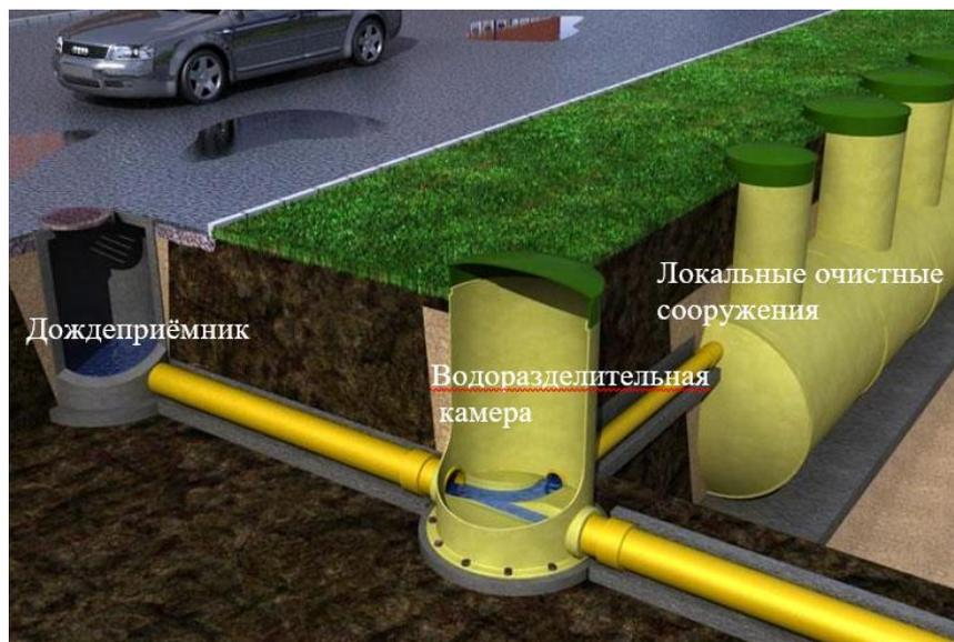
Рис. 3 – Пример установки водоразделительной камеры
