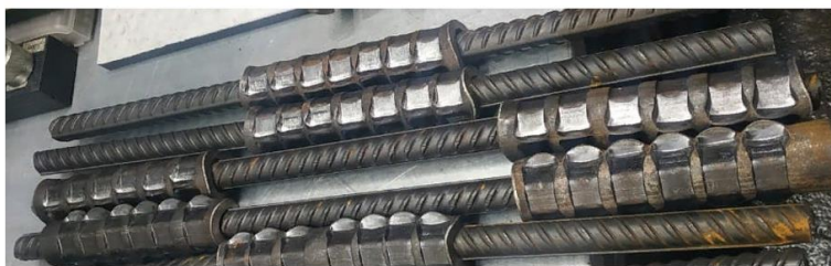
Рис. 1 – Опрессованные соединения арматуры:
