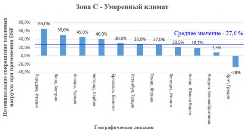
Рис. 3. Потенциальное сокращение тепловых нагрузок: а – в сухом климате; б – в умеренном климате; в – в континентальном климате
