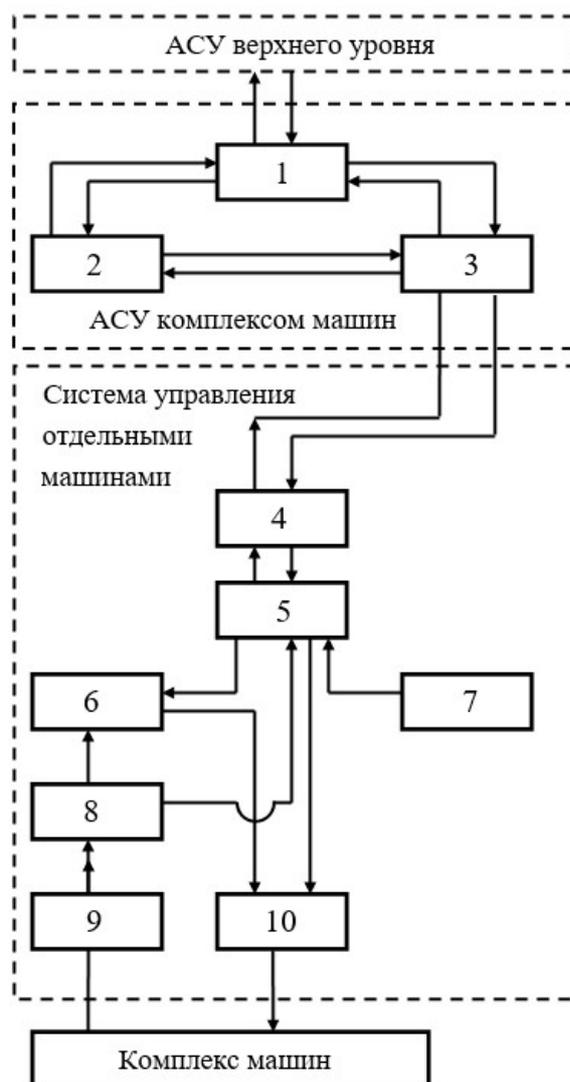
Рис. 2. Структурная схема АСУ: 1 – блок связи с АСУ верхнего уровня; 2 – персонал комплекса рабочих агрегатов; 3 – управляющая вычислительная машина (УВМ); 4 – устройство связи комплекса рабочих агрегатов с АСУ; 5 – контроллеры для управления отдельными технологическими машинами; 6 – регуляторы; 7 – устройства ручного ввода информации в контроллеры; 8 – преобразователи; 9 – датчики информации о параметрах рабочих агрегатов; 10 – исполнительные механизмы.
