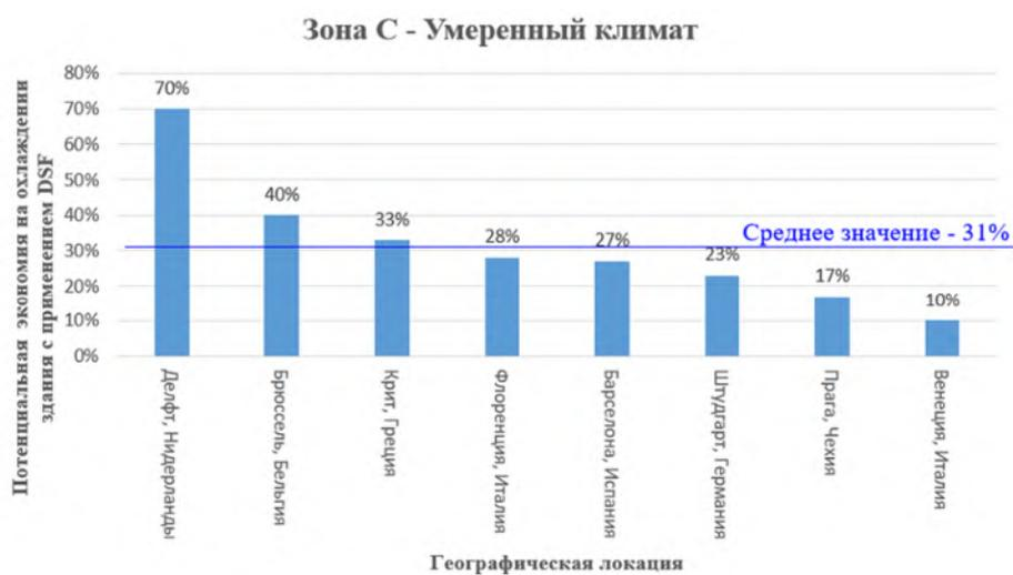
Рис. 4. Потенциальное сокращение энергетических затрат на охлаждение здания в жаркий период в умеренном климате
