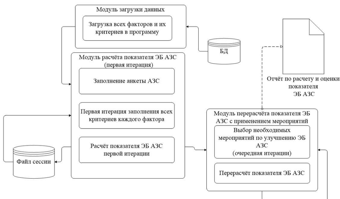
Рис. 2. Структурная схема программного приложения оценки ЭБ АЗС
