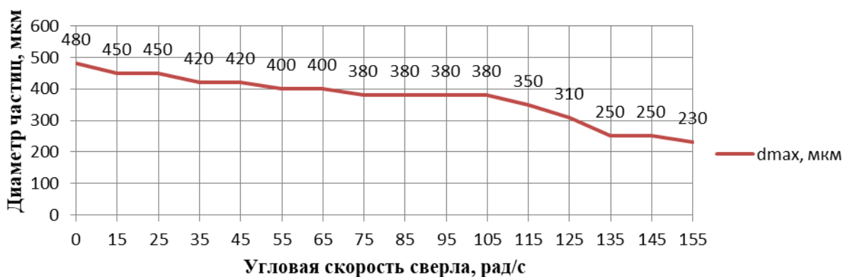
Рис. 6. Зависимость d_{\max} от угловой скорости сверла при Q = 0,01 кг/с, h = 95 мм, r = 10 мм
