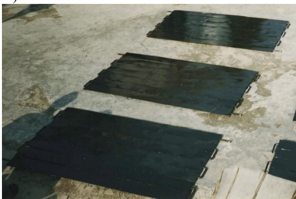
Рис. 2. Конструкция медного абсорбера солнечного коллектора: а – без покрытия; б – с покрытием чёрной краской
