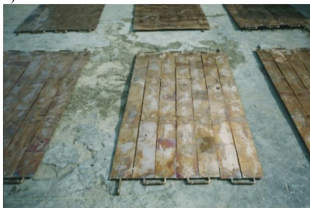
Рис. 2. Конструкция медного абсорбера солнечного коллектора: а – без покрытия; б – с покрытием чёрной краской
