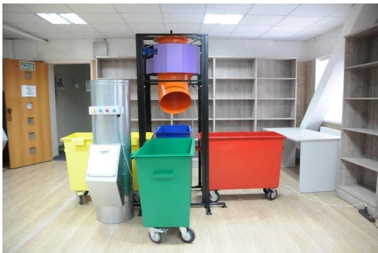
Рис. 2. Модель модернизированной конструкции в мусоросборной камере и приемного клапана мусоропровода компании «Градчист»
