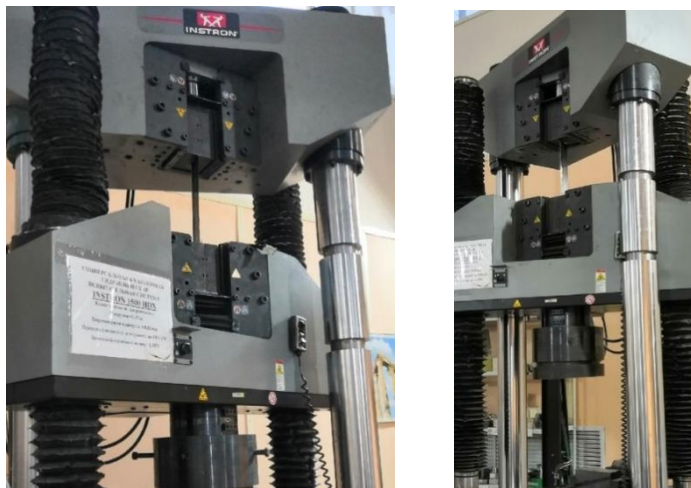
Рис. 4. Внешний вид оборудования в процессе проведения испытания УВ лент
