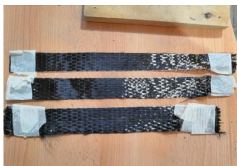
Рис. 3. Образцы УВ ленты CarbonWrap® Resin 230+ подготовленные для испытания
