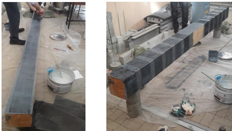
Рис. 11. Внешнее армирование цельного деревянного бруса УВ лентой
