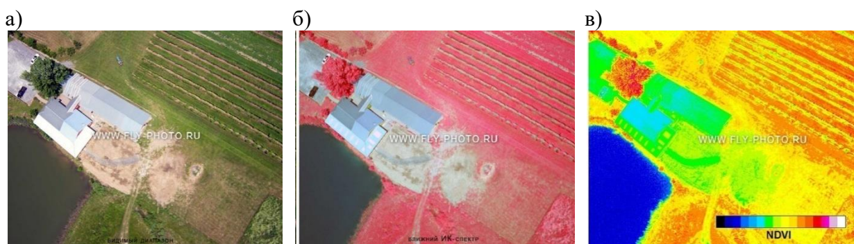
Рис. 2. Спектрональные снимки одного участка местности, несущие различную информацию: а – видимый диапазон; б – ближний инфракрасный спектр; в – в формате NDVI [Источник: URL: http://www.fly-photo.ru/giperspektralnaya.html ]
