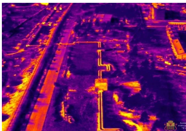
Рис. 5. Пример снимка в инфракрасном диапазоне для обнаружения мест повышенных теплопотерь на тепловой сети
