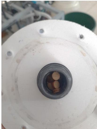
Рис. 3. Патрубок подачи исходной воды, забитый перемешивающей загрузкой
