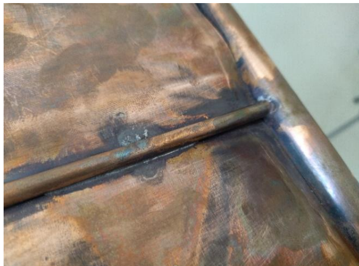
Рис. 2. Внешний вид паяного соединения «лист – труба – коллектор»
