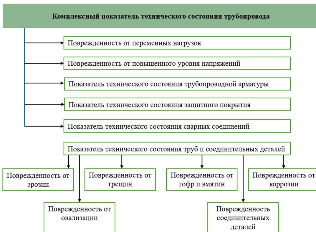
Рис. 1. Показатели, влияющие на оценку технического состояния трубопровода
