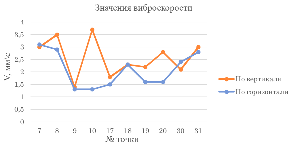
Рис. 4. Значения виброскорости в характерных точках трубопроводов в обвязке нагнетателя
