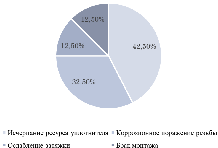
Рис. 1. Типовые отказы резьбовых соединений 1
